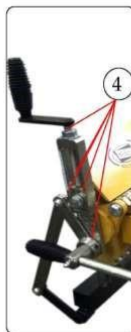
4 Смазывание подвижных точек механизма поднятия нажимной балки - типа загибание листа с четырех сторон (масленка)
